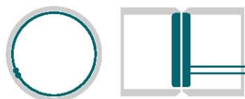
НАГРЕВ СВАРНОГО ШВА С УСТАНОВКОЙ ИНДУКТОРА ИЗНУТРИ ТРУБЫ
