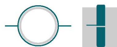
НАГРЕВ ДВУМЯ ИНДУКТОРАМИ, УСТАНОВЛЕННЫМИ ПОСЛЕДОВАТЕЛЬНО, ДЛЯ ТРУБ БОЛЬШОГО ДИАМЕТРА
